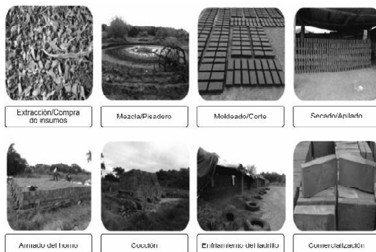
Ilustración 1: Diagrama de flujo de la fabricación de ladrillos artesanales. Fuente: elaboración propia.
